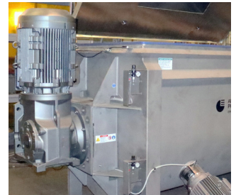
Transmisión directa, montaje de eje en ángulo recto
