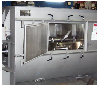
Puertas de acceso laterales
