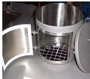
Puerto de entrada de supersacos
