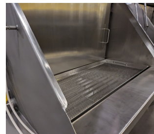
Montaje de la bandeja vibratoria
